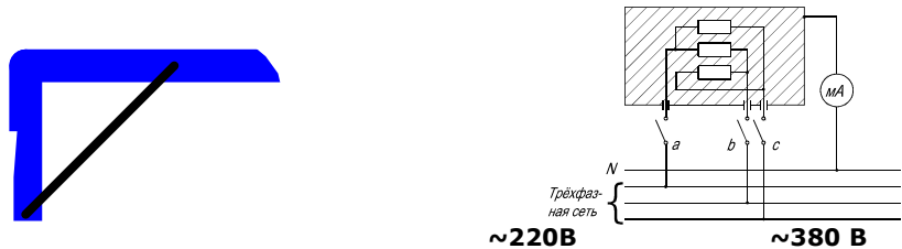
Рисунок 16 — Схема измерения тока утечки
